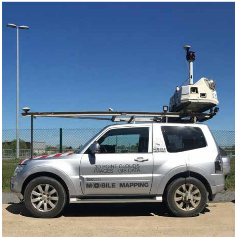
Om de verkeershinder te beperken werd een groot deel van de Brusselse ring opgemeten met een mobile mapping-systeem. Dit is een wagen uitgerust met sensoren die gelijktijdig 3D-laserdata en 360° foto's opnemen.
